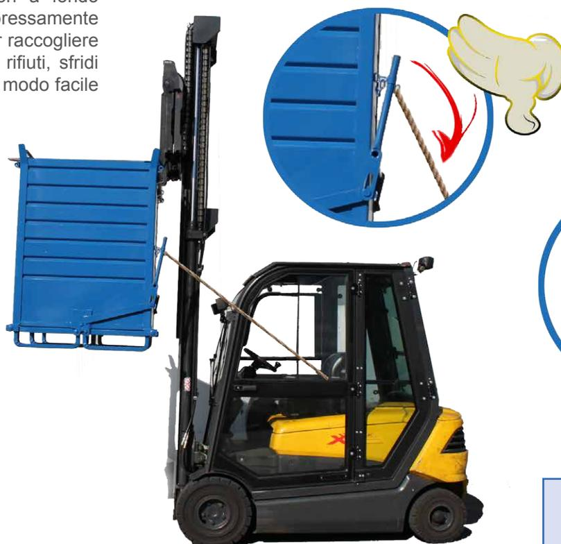
Lo svuotamento viene effettuato manualmente agendo su una semplice leva. Con una corda o una catena, l'operatore può aprire il fondo restando in sicurezza all'interno del carrello elevatore.
